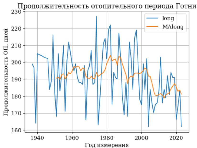
Рис.2. Продолжительность отопительных периодов: long – продолжительность отопительного периода по данным метеостанции, MAlong – округленные значения продолжительностей отопительного периода (скользящая средняя с периодом 10).
